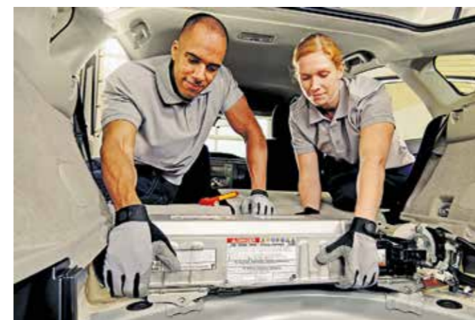
Frische Energie für das elektrische Fahren: Fachwerkstätten können gealterte Module etwa in einem Hybridfahrzeug erneuern. Foto: DJD/Robert Bosch
