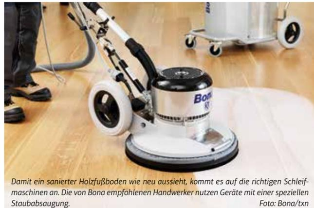
Damit ein sanierter Holzfußboden wie neu aussieht, kommt es auf die richtigen Schleifmaschinen an. Die von Bona empfohlenen Handwerker nutzen Geräte mit einer speziellen Staubabsaugung. Foto: Bona/txn
