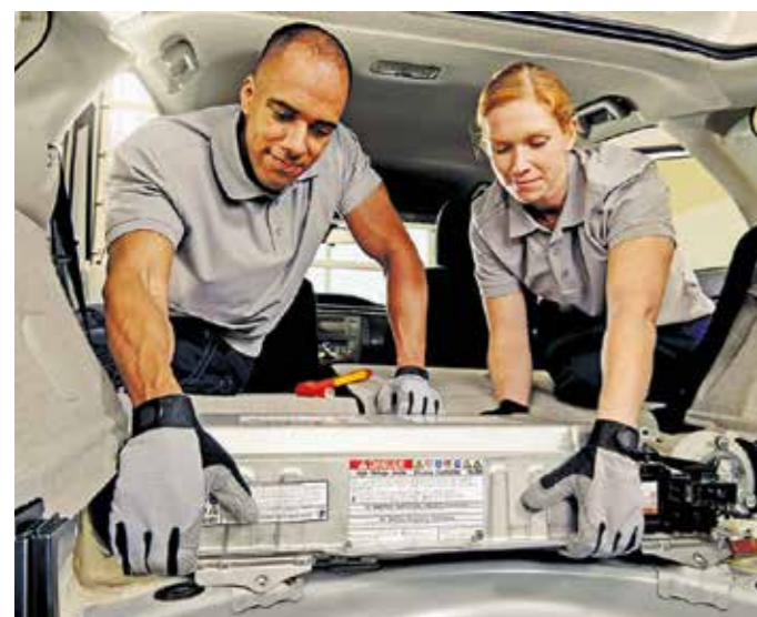
Frische Energie für das elektrische Fahren: Fachwerkstätten können gealterte Module etwa in einem Hybridfahrzeug erneuern. Foto: DJD/Robert Bosch
