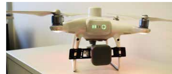
Drohne mit Fallschirm - Die Drohne des Katasteramtes darf nach ihrer Zwangslandung Ende 2022 wieder abheben. Neu ist der Fallschirm im grauen Kästchen, im Falle eines Absturzes verlangsamt er die Geschwindigkeit der herabfallenden Drohne. Eine neue EU-Regelung schreibt den Drohnenfallschirm aus Sicherheitsgründen vor. Foto: UvK / Ennepe-Ruhr-Kreis
