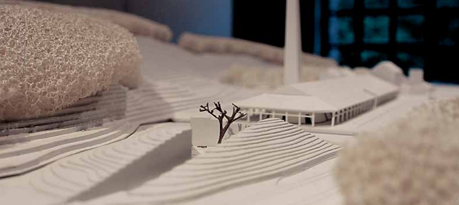
Die Zeche Nachtigall soll einen neuen Eingangsbereich bekommen. Ein Architekturwettbewerb wurde durchgeführt. 15 Arbeiten sind eingereicht worden. Der Siegerentwurf vom Architekturbüro ARGE puppendahlarchitekten aus Münster gruppiert drei Gebäudekörper um einen leicht abgesenkten Innenhof. Glasflächen öffnen die Gebäude zum Hof, während die aus dem Boden ragenden, dreieckigen Dachflächen teilweise begrünt sind. Sie sind begehbar und können als Wildblumenwiese, Spielplatz oder Aufenthaltsfläche dienen. Untergebracht werden sollen in den Gebäuden ein Besucherzentrum für das Muttental, ein Multifunktionsraum, eine Gastronomie sowie Kasse und Shop des LWL-Museums Zeche Nachtigall. Die Landschaft wächst von allen Seiten über die Gebäude hinweg und wird Tribüne, Spielhügel oder Biodiversitätenwiese. Die Anbindung an Stadt und Ruhrtalradweg sollen dadurch verbessert werden. Foto: JN
