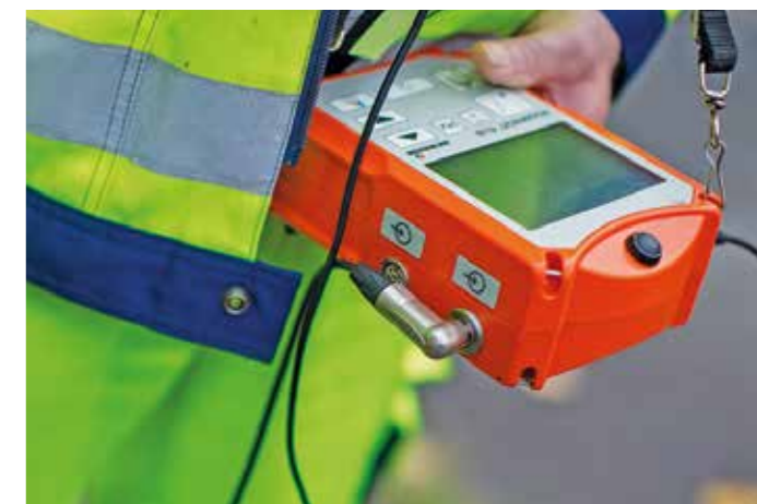
Gelsenwasser-Experten spüren gezielt und zeitnah unsichtbare Wasserleckstellen auf.
