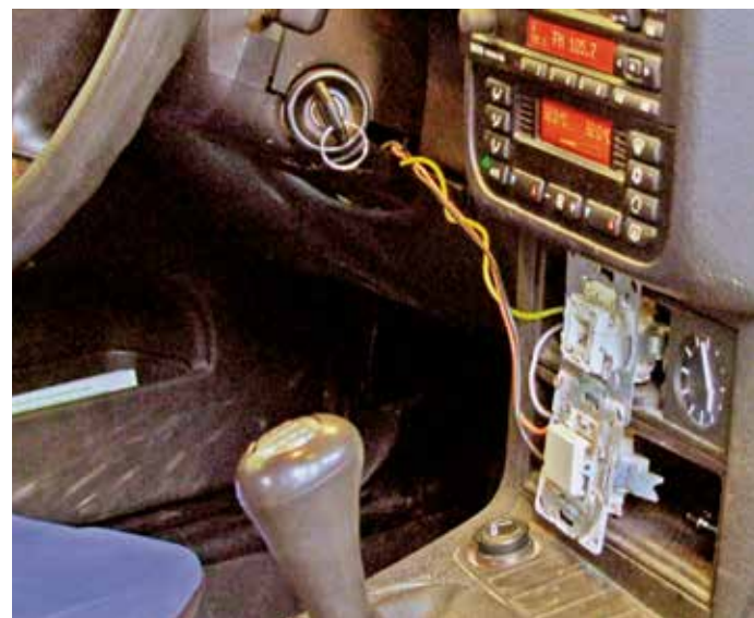
Von GTÜ-Prüfern entdeckt: Fragwürdige bis gefährliche „Bastelarbeiten“ im Auto, ein Starterknopf der etwas besonderen Art. Foto: Auto-Medienportal.Net/GTÜ
