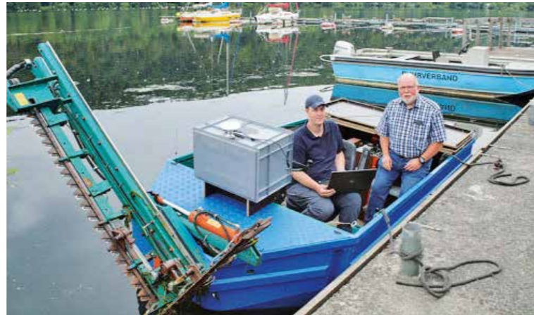
Mähboot mit neuer Technik: der von Stephan Werbeck entwickelte GPS-gestützte Fahrassistent optimiert das Freischneiden von Wasserflächen. Foto: FernUni Hagen
