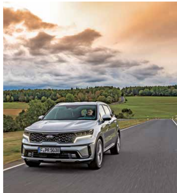
Der Benzin-Elektromotor-Zwitter entwickelt 230 PS (169 kW) Systemleistung und darf maximal 1,65 Tonnen ziehen (2,5 der Dieselantrieb). Der ist wahlweise mit Front- oder Allradantrieb erhältlich. Gut 90 Prozent der Kunden werden sich wohl für den Diesel entscheiden. Das soll sich erst ändern, wenn Anfang 2021 ein neuer Plug-in-Hybridantrieb mit 265 PS dazustoßen wird, von dem sich Kia dann fast die Hälfte der Sorento-Verkäufe verspricht. ampnet/fw
